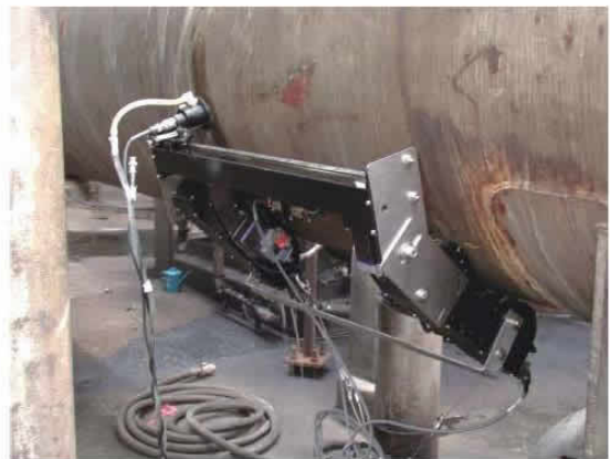
压力容器TOFD检测
